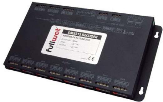
Señal DMX - distribuidor de señal y amplificador
