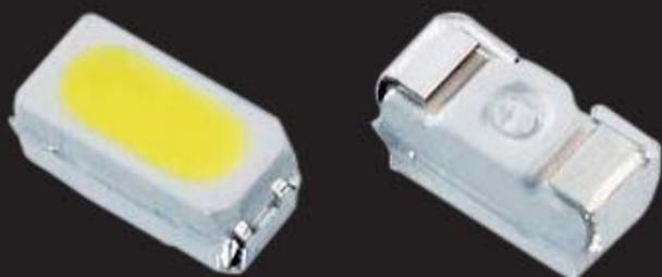
Las cápsulas tradicionales evacuan el calor solamente por los laterales y se produce una realimentación del mismo, que en condiciones de uso muy continuado a elevadas temperaturas, produce la destrucción del led.
